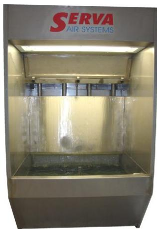
Les aspirations Dynaclean travaillent selon un système nouveau. DYNACLEAN ne comporte pas tous les éléments de construction existant sur les machines classiques et périodiquement bouchés comme les pompes, les buses, les valves, les filtres à eau et la tuyauterie. La circulation d'eau et l'effet de lessivage sont uniquement produits par la circulation d'air.
